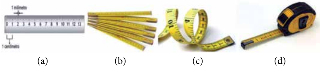
Fig. 1.7. Instrumentos de medición de longitudes, con escala en cm y mm. (a) Regla, (b) Metro plegable, (c) Cinta métrica plástica, (d) Cinta métrica metálica enrollada en su carcasa (flexómetro).
