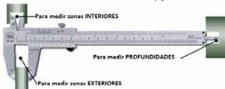
Fig. 1.8. Utilización del pie de rey en sus tres posibilidades: medición de exteriores, interiores y profundidad
