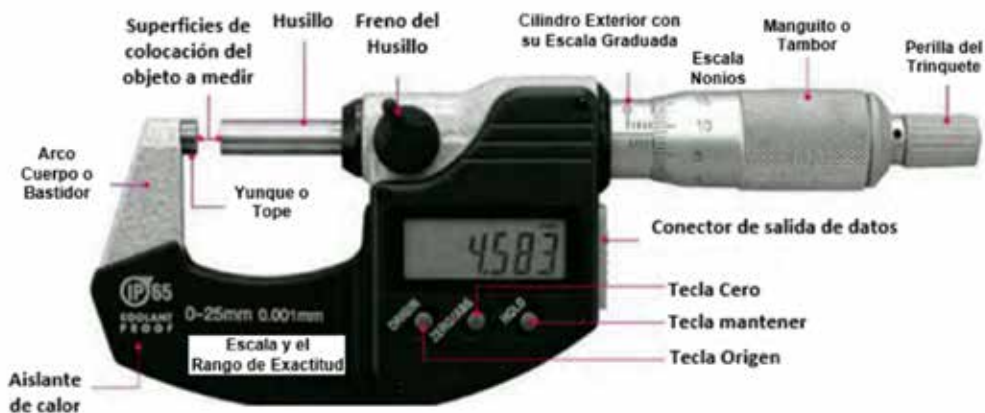
Fig. 1.13. Partes de un micrómetro
